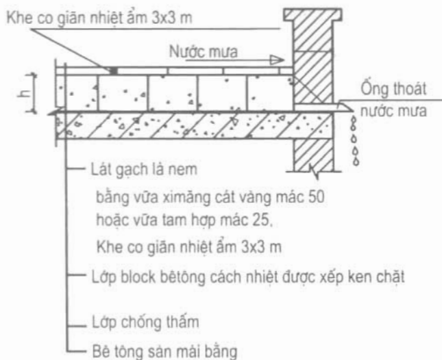
Hình 5.4. Sơ đồ chống nóng mái BTCT bằng vật liệu cách nhiệt tấm
