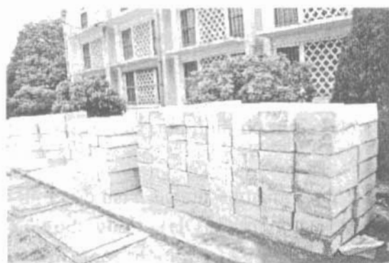
Hình 5.2. Sản phẩm Bloc và tấm tường lắp nhanh từ bê tông Polystyrene [67]
