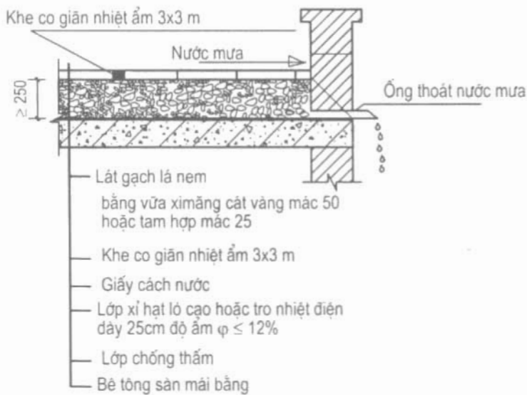
Hình 5.3. Sơ đồ cách nhiệt mái BTCT bằng vật liệu rời
